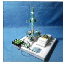
オルゴールのゼンマイの力で回転するピカピカ光るイルミネーション装置をつくらう
