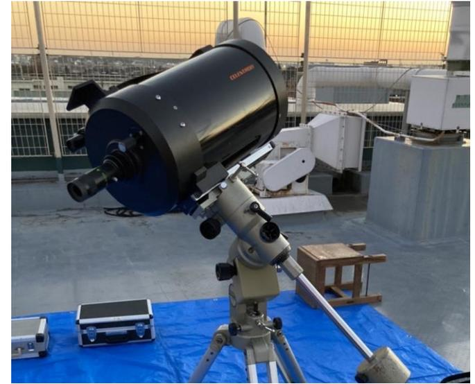
反射屈折望遠鏡
