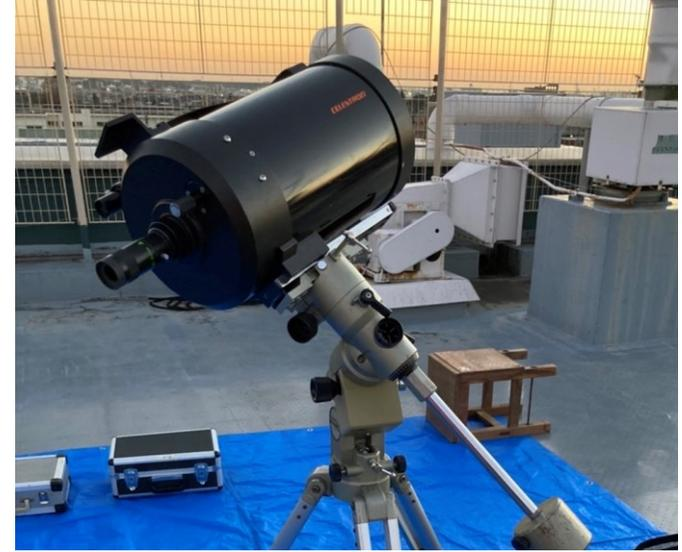
反射屈折望遠鏡
