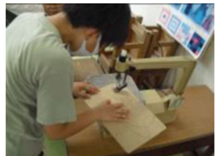
【電動糸のこぎりを安全に正しく使って木の板を切ります】
