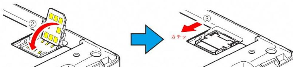
5. 充電電池パックのリサイクルマークが印刷されている面を上にして、製品の端子部と充電パックの▲を合わせ①の方向に取り付けて、②の方向にはめ込んでください。
