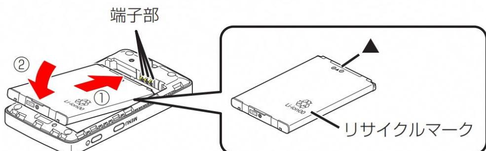
6. 充電池カバーの向きを確認して製品に合わせるように装着し、以下イラスト内の○の部分をしっかりと押しながらすき間がないように取り付けてください
