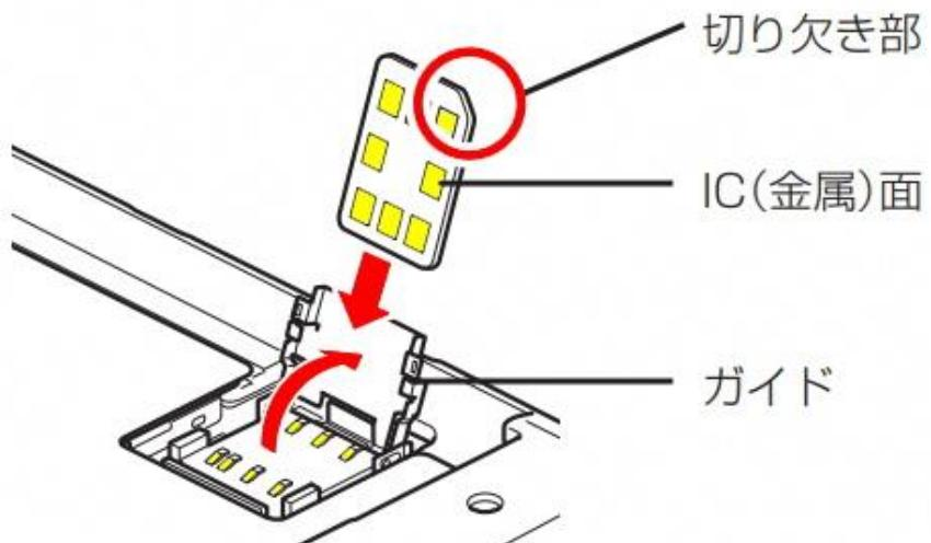
4. カバーを矢印方向（②）手前に倒し、水平な状態でカバーを軽く押しながら矢印方向（③）にカチッと音がするまでスライドさせ、ロックしてください
