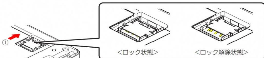
3. カバーを立ち上げ、nanoSIM カードの IC（金属）面を上側にして、カバーのガイドに沿ってまっすぐ挿入してください
